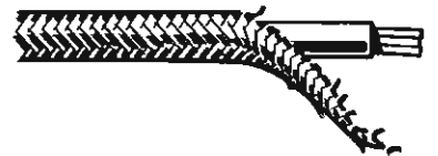
Envoltura de malla de los cables blindados
